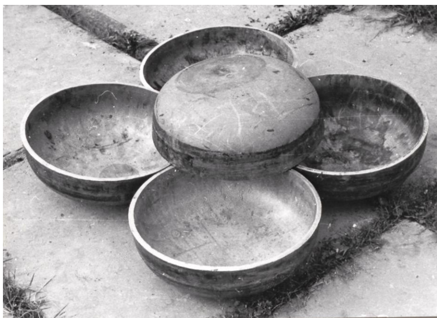
Рис.2. Детали типа «дно эллиптическое», диаметр 500мм, толщина стенки 10мм, материал 12X18Н10Т.
