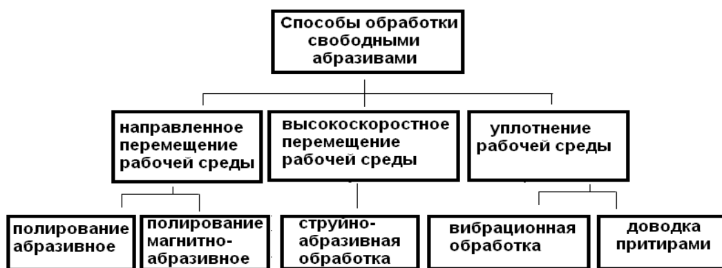
Рис. 2. Классификация способов обработки свободными абразивами по характеру воздействия абразивной частицы
