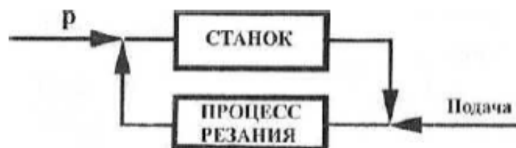
Рис. 1– Станок и процесс резания, как замкнутый контур
