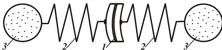
Рис. 4.87. Устройство из пьезоэлектрических элементов, пружин и шаров для шлифования: 1 – пьезоэлектрический элемент; 2 – пружина; 3 – шар.
