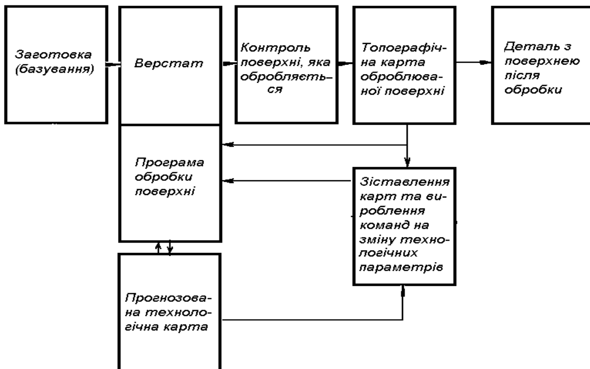
Рис. 4. Структурна схема процесу автоматизованого формоутворення при абразивній обробці
