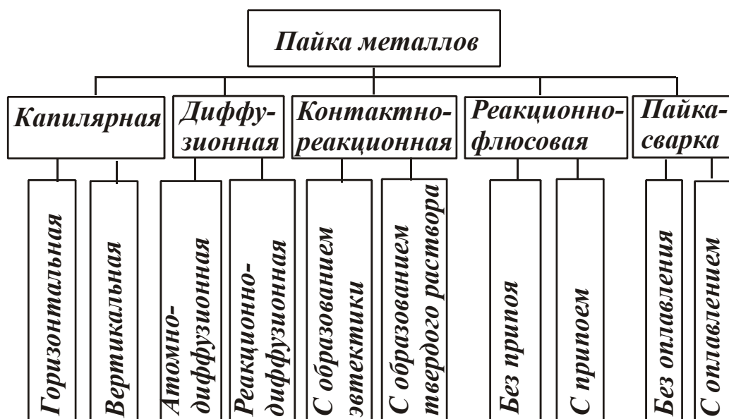
Рис. 12.13. Разновидности методов пайки
