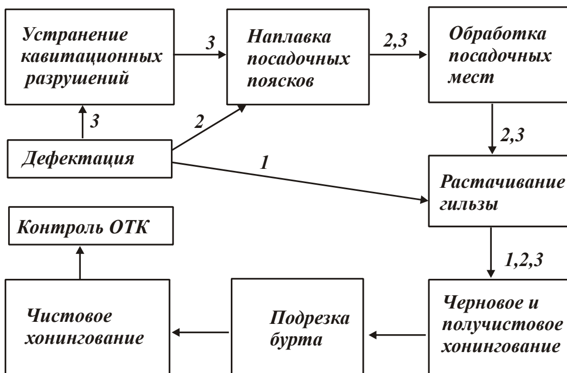
Рис. 12.21. Схема технологического процесса восстановления гильз цилиндров: 1, 2 и 3 – маршруты восстановления
