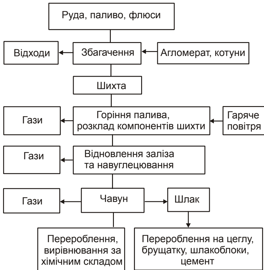
Рис. 4. Схема процесів у технологічній системі виготовлення чавуну
