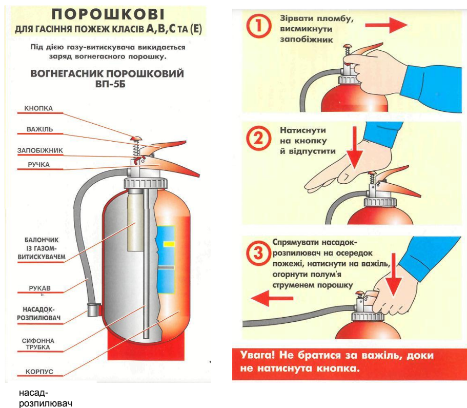
Рис. 2. Порошкові вогнегасники та порядок приведення їх у дію
