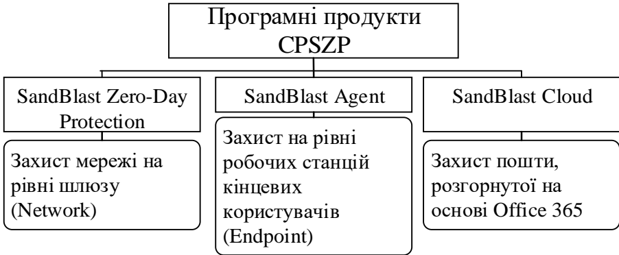
Рисунок 1.34 – Програмні продукти в рамках Check Point SandBlast Zero-Day Protection
