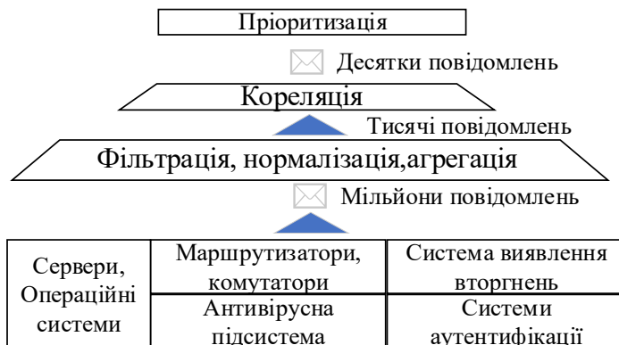
Рисунок 2.7 – Спрощена схема пріоритизації повідомлень в SIEM-системі
