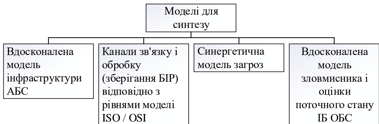
Рисунок 3.3 – Синтез чотирьох моделей для оцінки поточного стану ІБ
