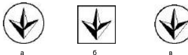
Рис. 1. Национальные знаки соответствия при обязательной (а) и добровольной (б) сертификации, требованиям технических регламентов (в)
