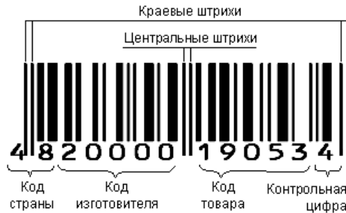
Рис. 2. Структура штрихового кода EAN-13
