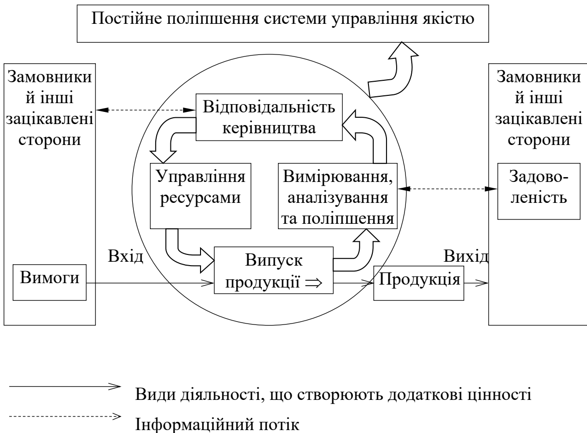
Рисунок 4.4 – Модель системи управління якістю, що базується на процесному підході
