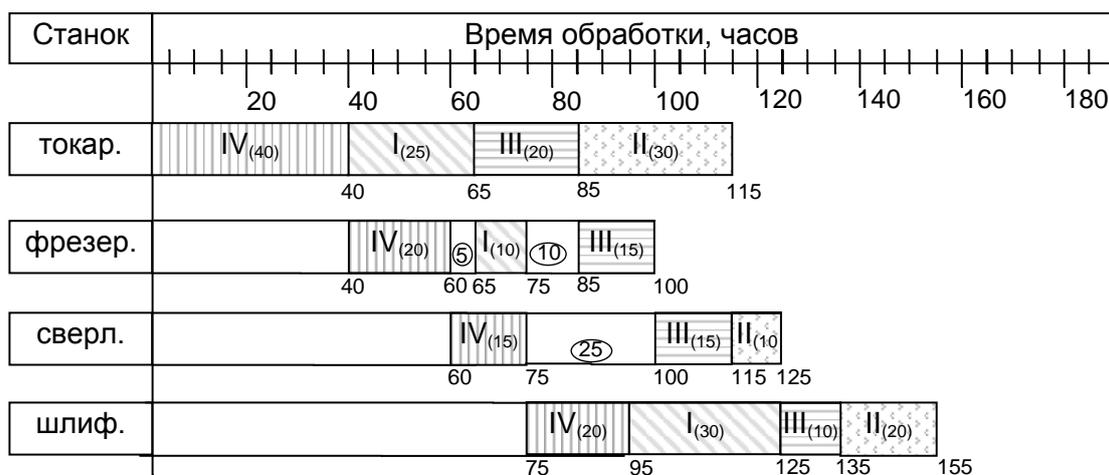
**Рис. 3. График Ганта для третьего варианта последовательности запуска деталей в обработку**
