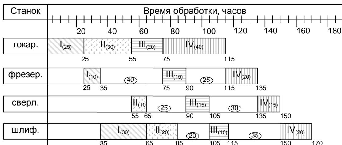
**Рис. 1. График Ганта для первого варианта последовательности запуска деталей в обработку**
