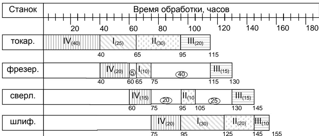
**Рис. 2. График Ганта для второго варианта последовательности запуска деталей в обработку**
