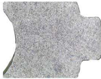
1. Фрагмент диска дверного замка з латуні Л63
