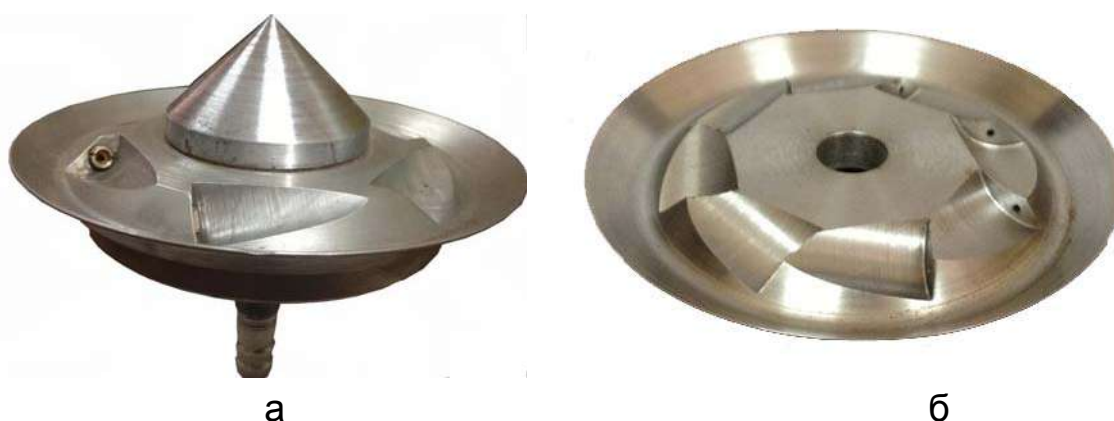
Рис. 4.14. Завихрювачі зі змінними надзвуковими соплами Лавалю
