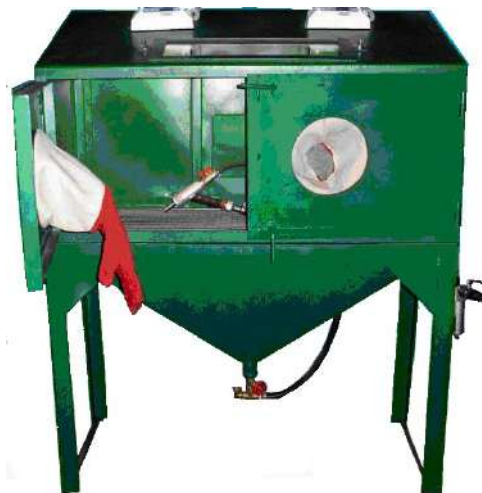
Рис. 1.38. Зовнішній вигляд піскоструминної камери КАО-300 робочим об'ємом 0,3 м 3
