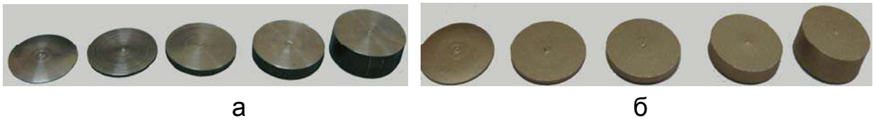
Рис. 6.10. Зразки з латуні ЛС59.1 у формі диска діаметром 20 мм і товщиною 0,5; 1; 2; 4 і 8 мм до обробки (а) і після обробки (б)
