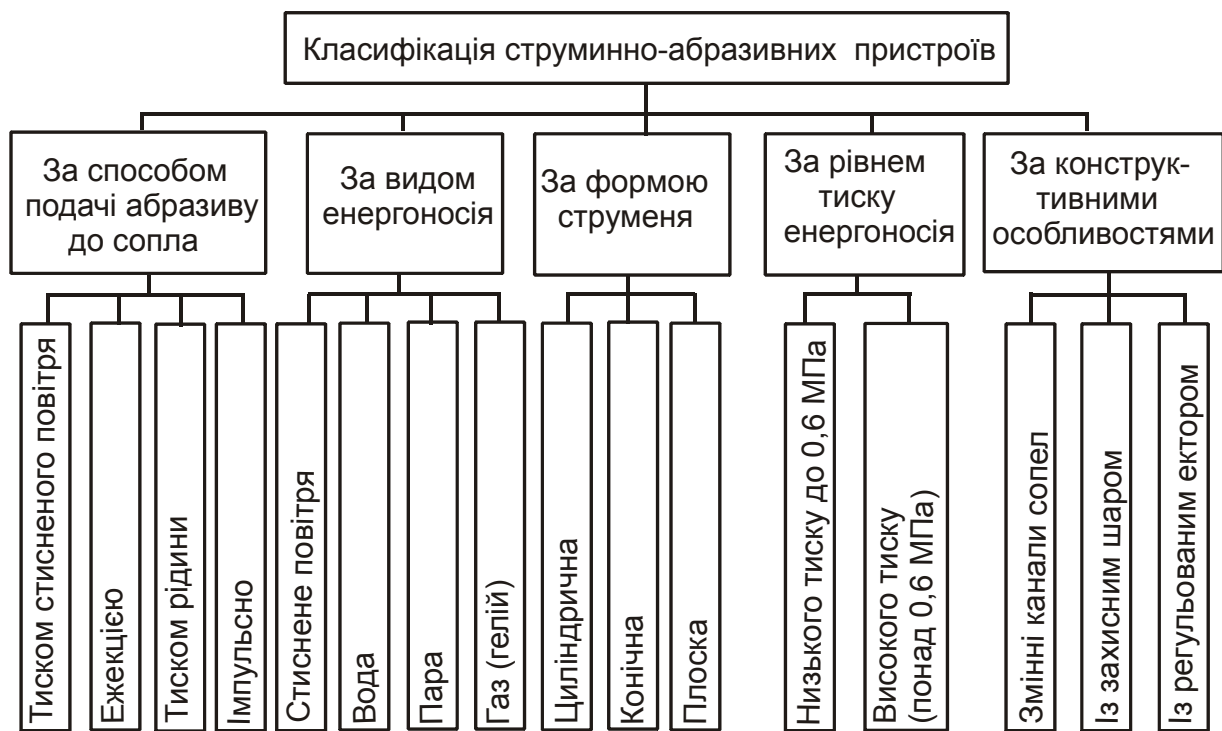
Рис. 1.41. Класифікація струминно-абразивних пристроїв
