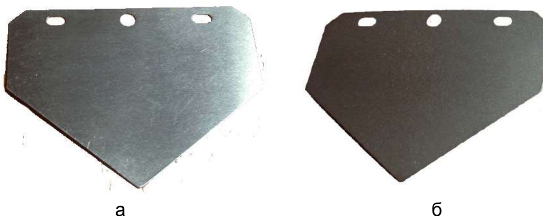
Рис. 5.9. Зовнішній вигляд поверхонь деталей, утворених у результаті шліфування (а) і абразивної обробки затопленими струменями (б)
