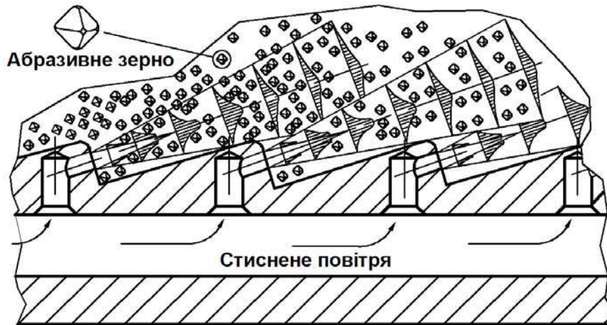
Рис. 3.27. Фрагмент соплового апарата струминно-абразивної установки
