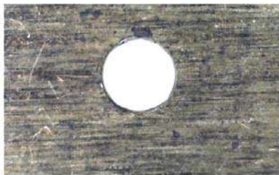
1. Фрагмент диска дверного замка з латуні Л63
