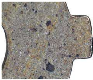
1. Фрагмент диска дверного замка з латуні Л63
