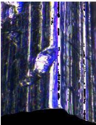
Рис. 5.22. Фотографія кромки одного з торців листової деталі зі слідом абразивного зерна, збільшена у 850 разів
