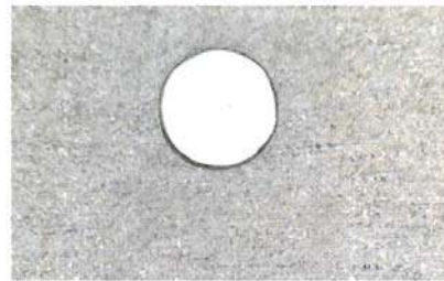
1. Фрагмент диска дверного замка з латуні Л63
