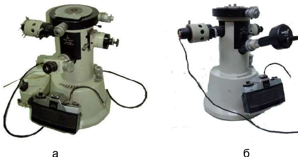
Рис. 4.9. Мікроінтерферометр моделі MII-4B42 (а) і мікроінтерферометр моделі MII-4B42 з електронною насадкою моделі ScopeTek MDC 140N фірми "Levenhuk"
