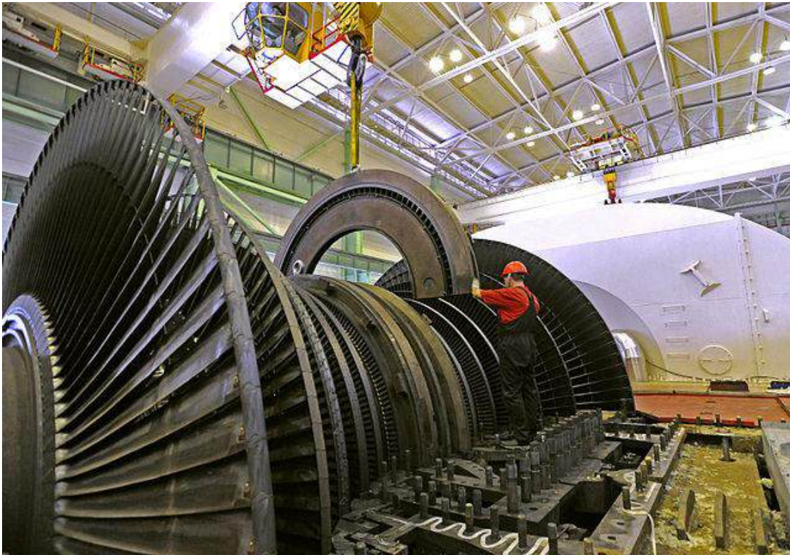
Рисунок 4.18 – Парова турбіна низького тиску в експлуатації нижче атмосферного тиску в атомній електростанції
