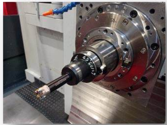
Рисунок 7.7 – Фреза від компанії Іскар серії HELI-6-FEED
