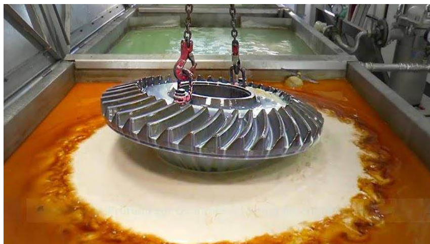
Рисунок 7.25 – Ультразвукова обробка металевого виробу
