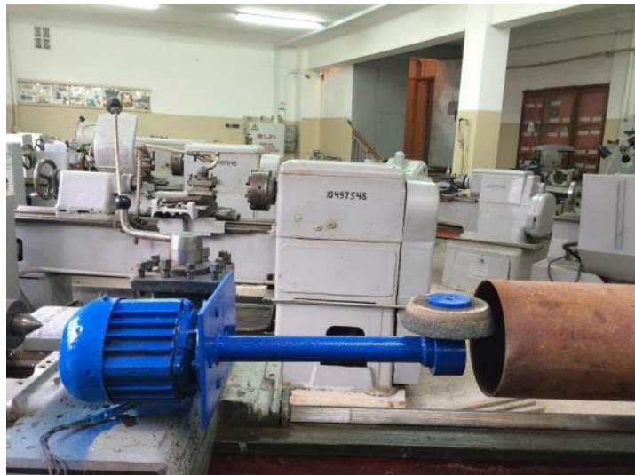
Рисунок 8.58 – Схема обробки шліфуванням отвору у циліндрі
