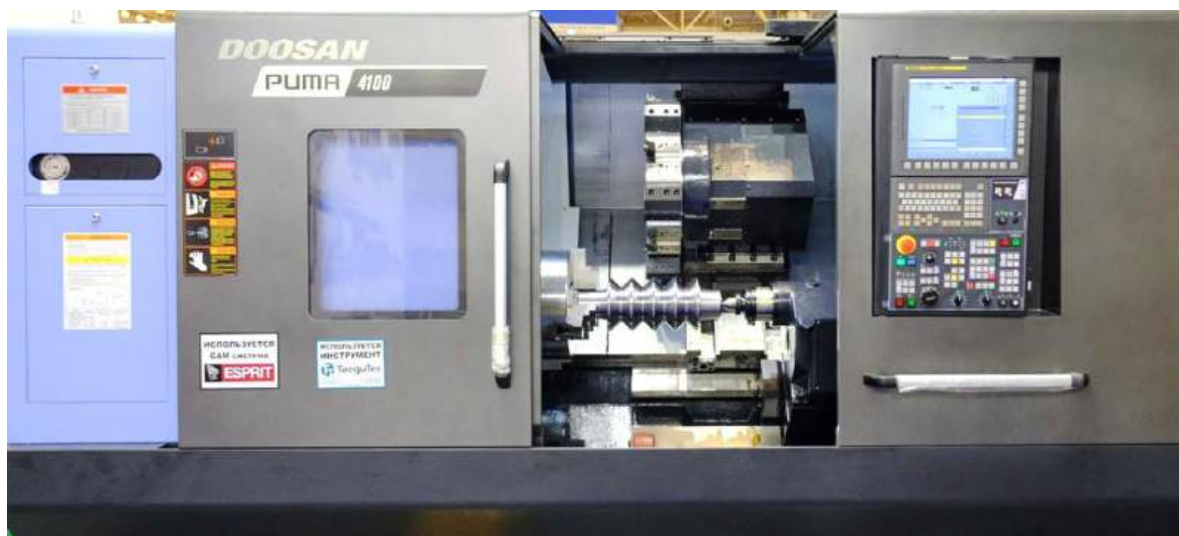
Рисунок 7.3 – Обробка деталі "Прокатний валок" на високопотужному токарному обробному центрі PUMA 4100B
