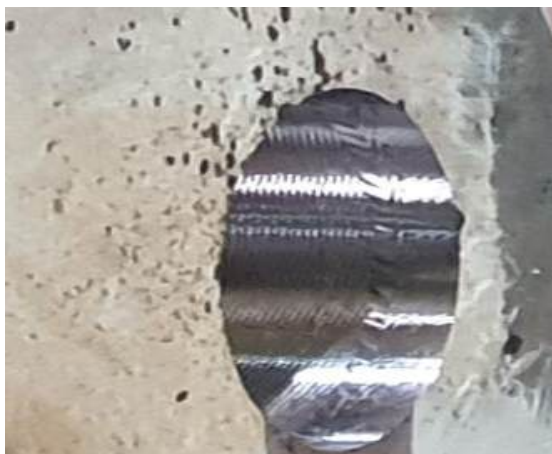
Рисунок 7.10 – Порівняння якості обробки отвору "до" (а) впровадження інструменту FF від компанії Іскар та "після" (б)
