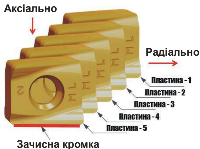
Рисунок 7.12 – Розташування пластин на корпусі фрези
