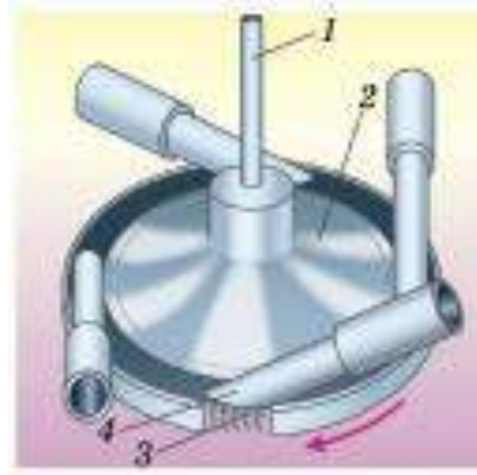
Рисунок 4.15 – Схема роботи парової машини: 1 – вал; 2 – диск; 3 – лопатки; 4 – сопло (через нього подається пар під високим тиском)
