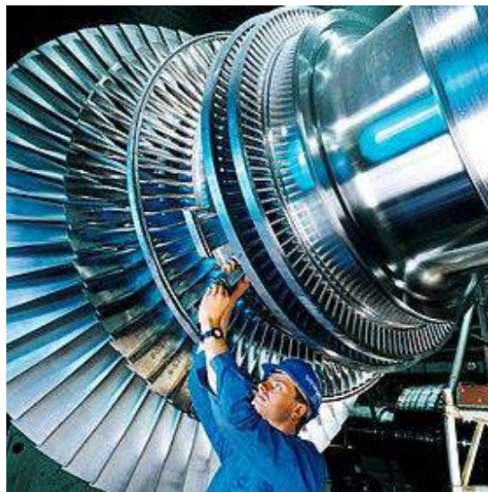
Рисунок 4.16 – Сучасна парова турбіна із багатьма дисками (із лопатками, через які проходить пар)
