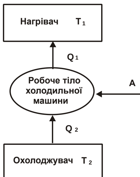
Рисунок 4.24 – Принцип дії холодильної машини
