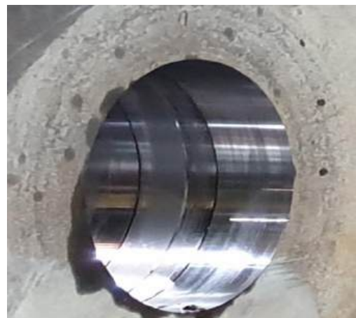
Рисунок 7.10 – Порівняння якості обробки отвору "до" (а) впровадження інструменту FF від компанії Іскар та "після" (б)
