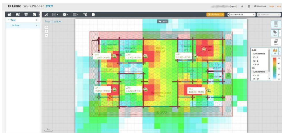
Рис. 7.25. Налаштування відображення зон покриття відповідно до вибраного діапазону та каналів ТД
