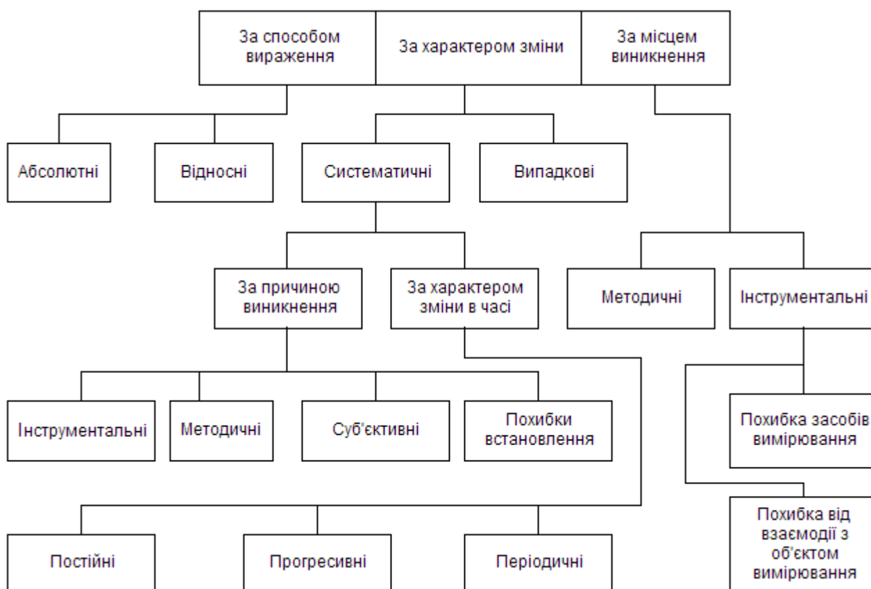
Рисунок 2.45 – Класифікація похибок вимірювання
