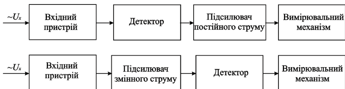
Рисунок 2.18 – Структурні схеми електронного вольтметра змінного струму
