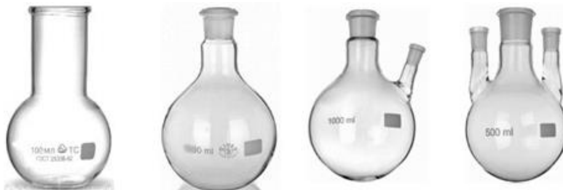
Рисунок 2.45 – Колби з плоским та круглим дном: плоскодонна звичайна; плоскодонна зі шліфом; круглодонна з двома горловинами зі шліфом; круглодонна з трьома горловинами зі шліфом
