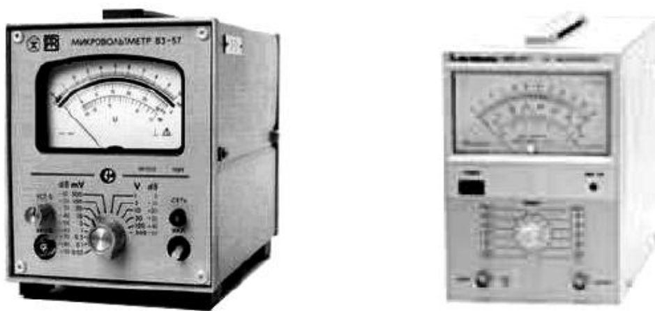
Рисунок 2.19 – Зовнішній вигляд електронних аналогових вольтметрів: а – мікрвольтметр ВЗ-57; б – мілівольтметр АВМ-1071
