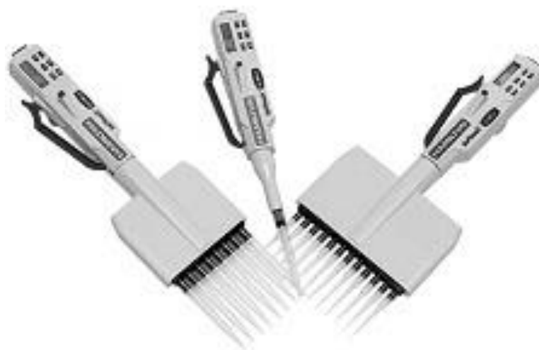
Рисунок 2.60 – Одноканальні та багатоканальні автоматичні піпетки
