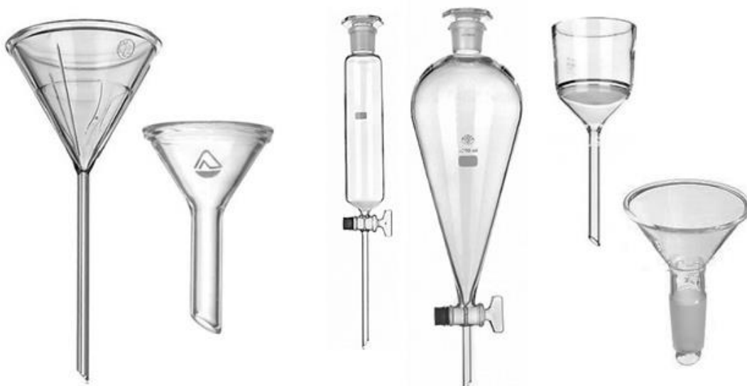
Рисунок 2.44 – Лійки: лабораторна з довгим стеблом; лабораторна з коротким стеблом; ділильна циліндрична зі скляним краном; ділильна грушоподібна з тефлоновим краном; фільтруюча з пористим диском без шліфа; фільтруюча з пористим диском зі шліфом
