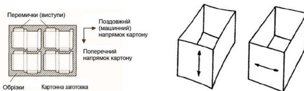
Рис. 8.4. Залежність жорсткості коробок від машинного напрямку картону
