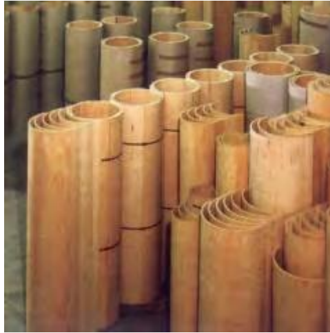
Рис. 7.29. Заготовки з дерева для ротаційних штанцформ
