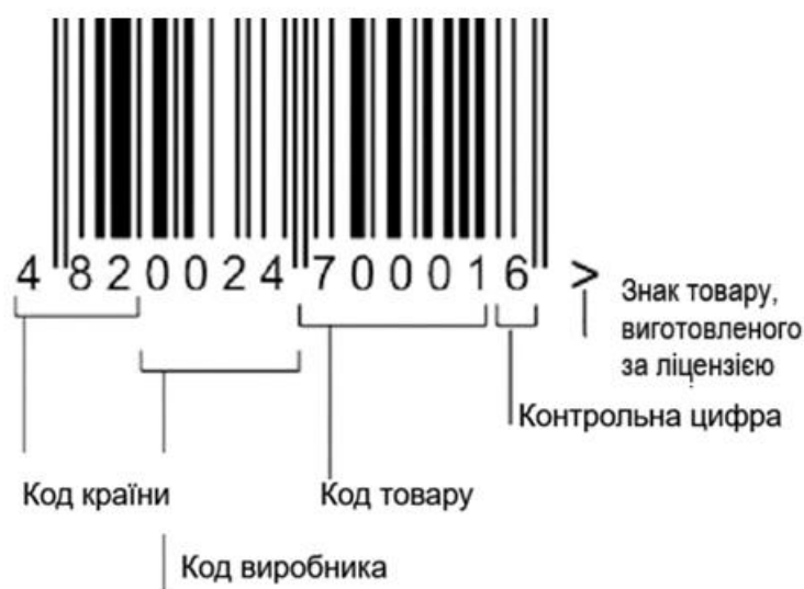
Рис. 6.45. Структура 13-розрядного коду. Зразок штрих-коду в системі EAN-13
