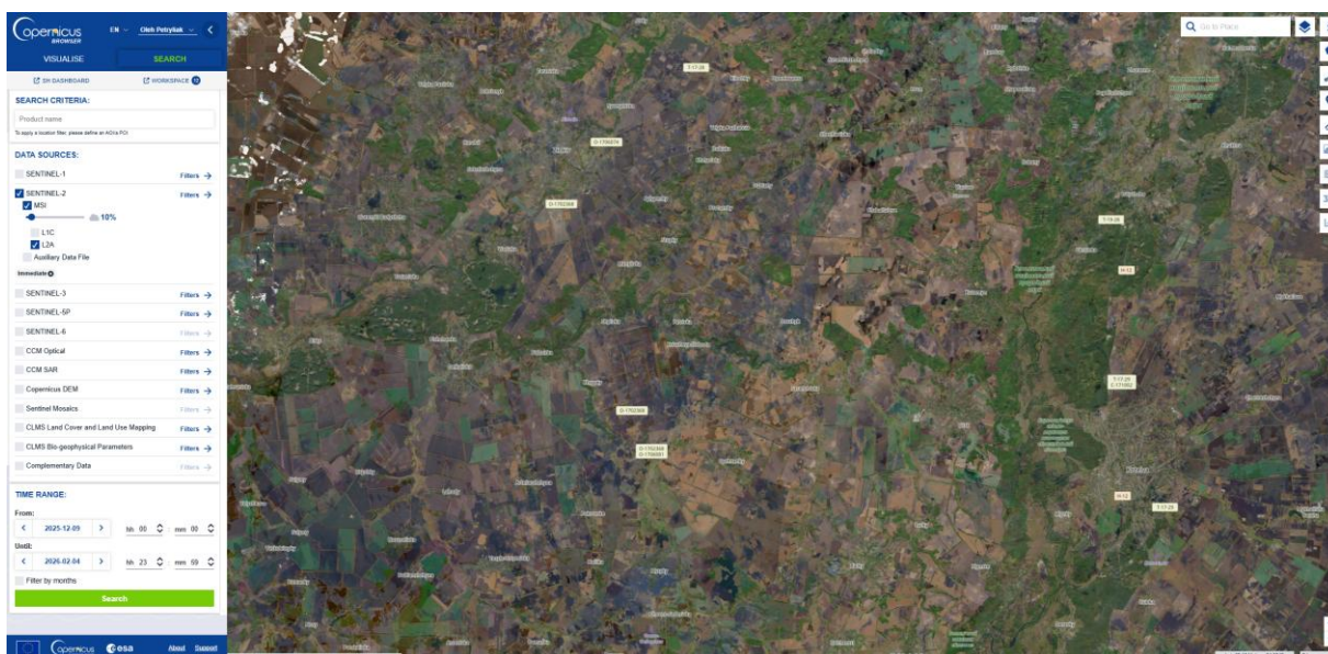
Рис. 1 – Приклад роботи в Copernicus Browser: вибір області на карті, часових меж і фільтрів для пошуку даних Sentinel
