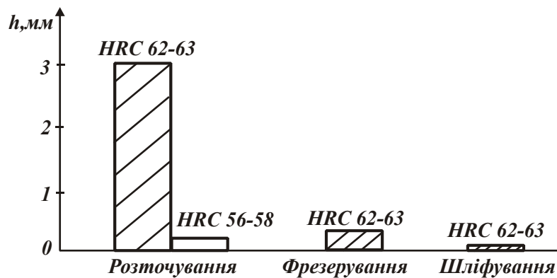
Рис. 7. Вплив методу обробки отворів на величину відколів
