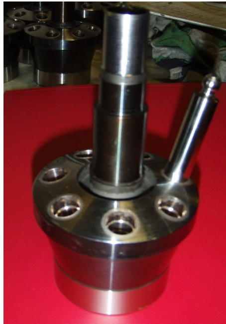
Рис. 3. Пара тертя ротора з плунжером
