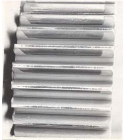
Рис. 2. Зубчатое колесо с продольными трещинами во впадине
