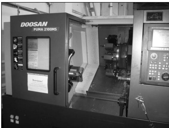
Высокопроизводительный двухшпиндельный токарный обрабатывающий центр PUMA 2100MS с приводным фрезерным инструментом (ось С) и контр-шпинделем ("DOOSAN").
