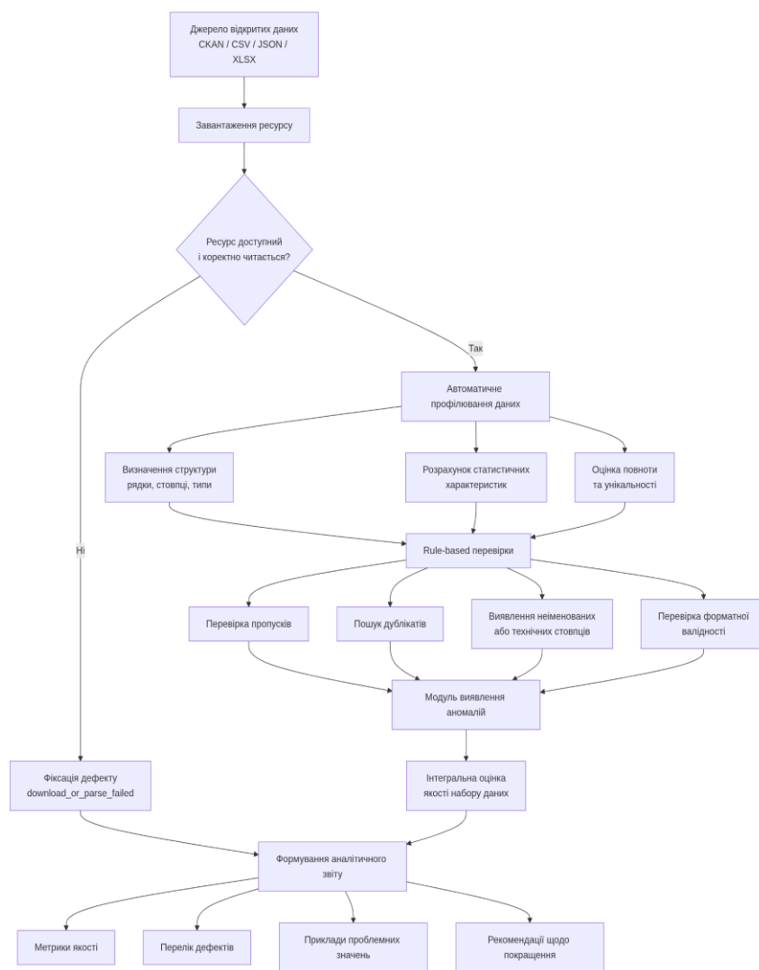
Мал. 1. Архітектура автоматизованого оцінювання якості відкритих даних
