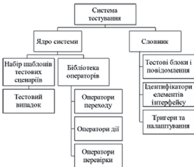
Рис. 2. Структура системи автоматичного тестування з використанням шаблонів
