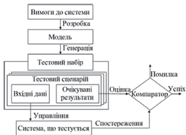
Рис. 1. Генерація сценаріїв тестування на основі моделі веб-застосунку
