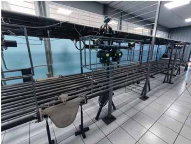
Рис. 1.1. Гідравлічна пілотна установка, використана для експериментальної перевірки гібридного підходу до виявлення витоків і керування тиском у водопровідній мережі [4, с. 2]
