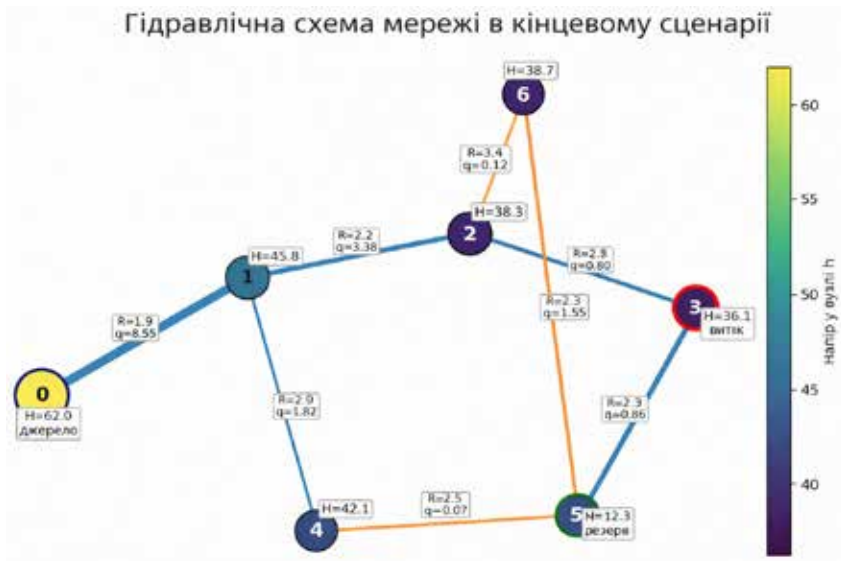
Рис. 2.6. Гідравлічна схема мережі у сценарії “витік + резервування” з розподілом напорів, витрат у гілках та позначенням критичних вузлів
