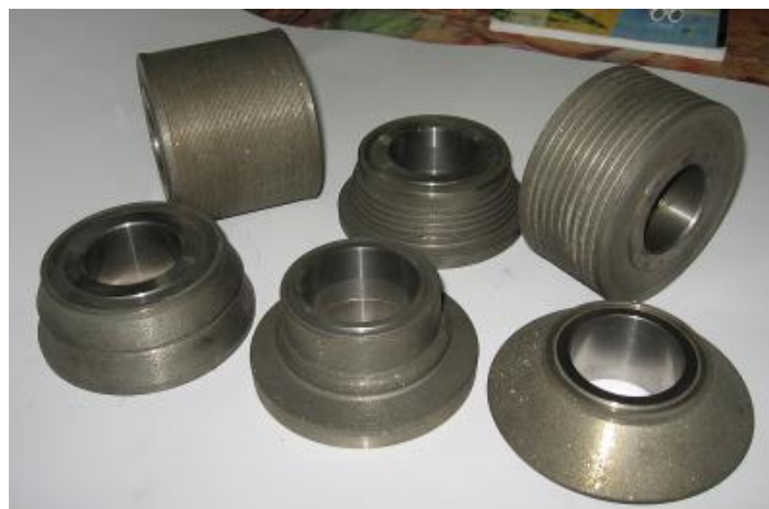
Рис. 1.17 – Прецизионные алмазные правящие ролики
