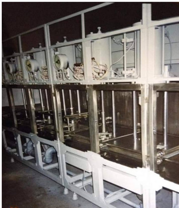
Рис. 8.10 – На автоматической линии в верхней части расположены пневмоцилиндры, внутренние поверхности которых обработаны по новой технологии
