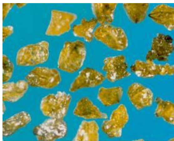
Рис. 1.3 – Искусственные алмазы марки АС6 160/125 (производства ИСМ им. В. Н. Бакуля)
