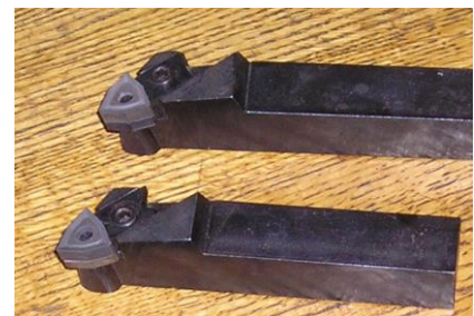
Рис. 7.27 – Универсально-сборные резцы для обработки точением: а, б, в – резцы с поворотной рабочей частью (Патенты Украины: 12364А и 51167А), г – резцы со сменными вставками (Патенты Украины: 22060А, 51165А, 63498А, 52664, 54442)
