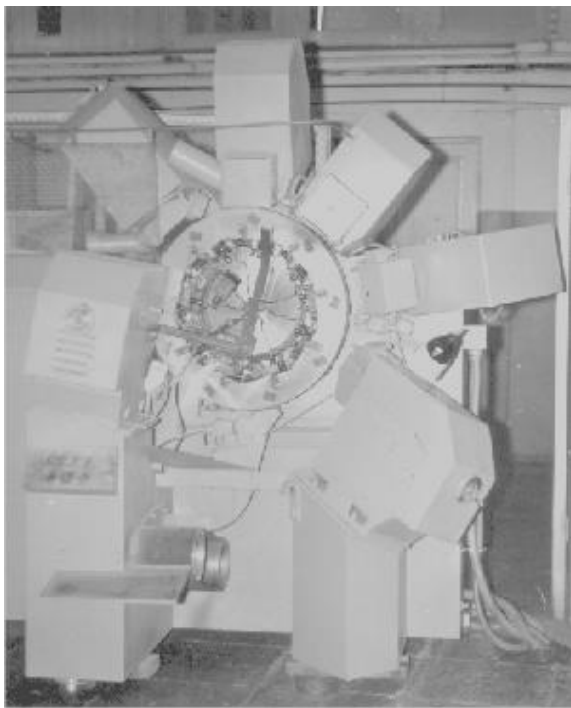
Рис. 1.6 – Станок-автомат модели М3-54 для полной алмазной заточки твердосплавных резцов
