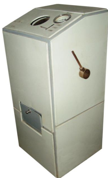
Рис. 8.17 – Струйно-абразивная установка для обработки мелких деталей
