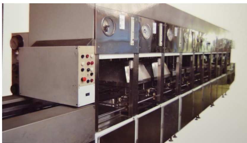
Рис. 8.11 – Автоматическая линия ампулирования лекарственных средств, изготовленная в лабораториях кафедры "Технология машиностроения"
