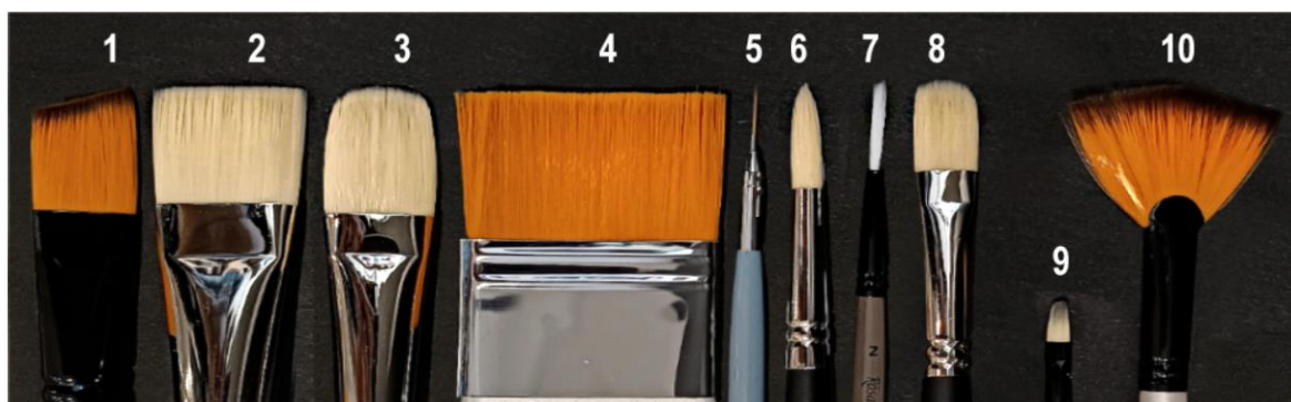
Рис. 2.39. Синтетичні пензлі різних форм: 1 – скошена; 2 – плоска; 3, 8, 9 – овальна; 4 – флейц; 5, 7 – лайнер; 6 – кругла; 10 – віяло
