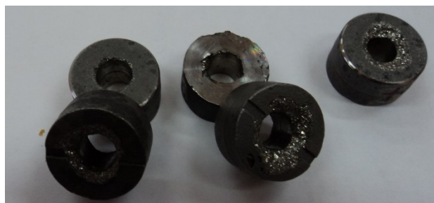
Рис. 6. Кільця з магнітного сплаву АНКО-3А після розточування в них отворів
