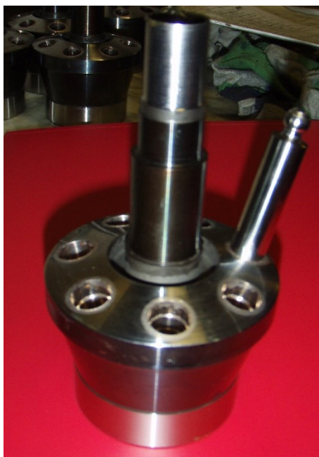
Рис. 3. Пара тертя ротора з плунжером
