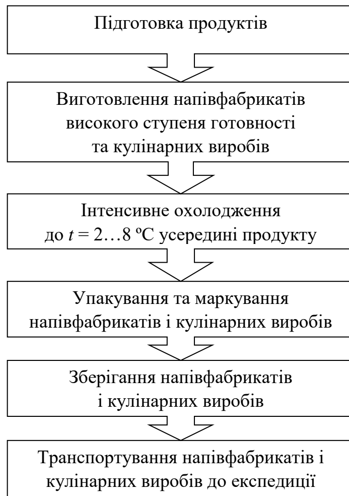
Рисунок 3.9 – Загальна схема організації виробничих процесів у кулінарному цеху
