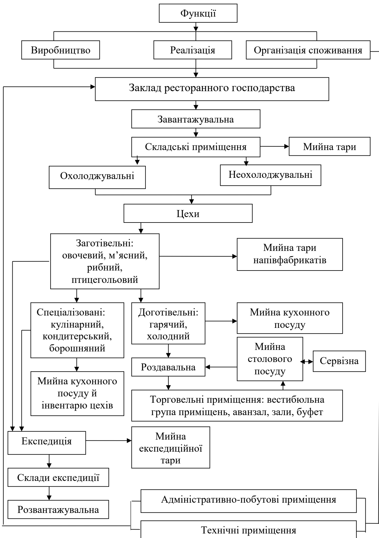
Рисунок 1.16 – Виробничо-торговельна структура закладу ресторанного господарства з повним технологічним циклом
