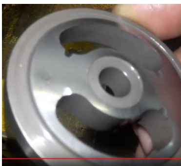
Фото 1 – 3. Выпуклые сферы распределителей, вогнутые – сферы блоков-цилиндров
