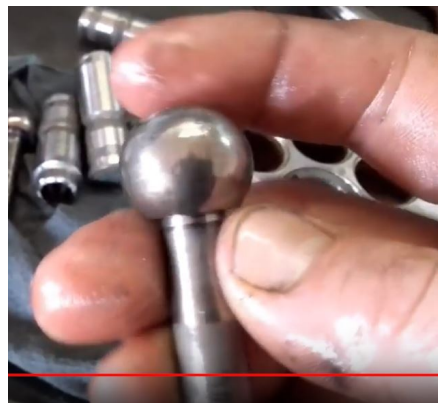
Сферические гнезда на торцах валов (фото 8) и сферические головки центральных шипов и шатунов (фото 9)
