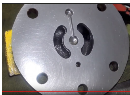
Фото 4, 5. Шлифование торца задней крышки
