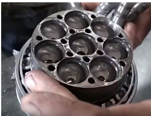
Сферические гнезда на торцах валов (фото 8) и сферические головки центральных шипов и шатунов (фото 9)
