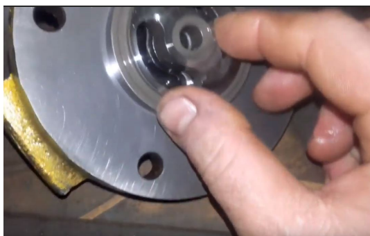
Фото 6, 7. Плоские торцы распределителей и задних крышек
