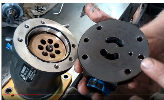
Фото 4, 5. Шлифование торца задней крышки
