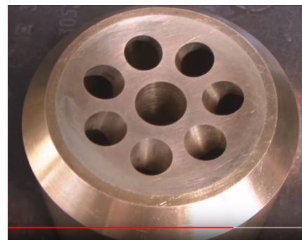
Фото 1 – 3. Выпуклые сферы распределителей, вогнутые – сферы блоков-цилиндров
