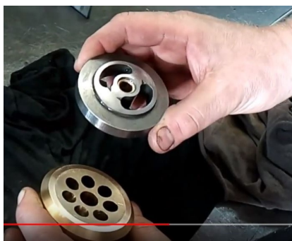
Фото 1 – 3. Выпуклые сферы распределителей, вогнутые – сферы блоков-цилиндров
